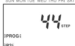
Phím **[MODE]** được nhấn trong 3 giây trong mode RUN, "PROG P1" nháy và nhấn phím **[MODE]** lần nữa, "PROG P2" nháy và nhấn phím **[SET]**.
