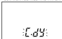
Nhấn phím [MODE] trên 3 giây để di chuyển đến cài đặt nhóm 1 trong mode RUN và nhấn nó lặp lại nhiều lần đến khi "L-dy" nháy trong phần hiển thị giây và nhấn phím [SET].
