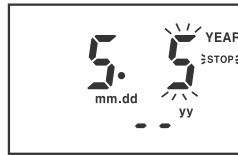
Phần đang nháy được di chuyển trực tiếp đến vị trí tháng và nhấn phím [▲] để cài đặt May và nhấn phím [ ] đến khi vị trí ngày nháy. Nhấn phím [SET] sau khi cài đặt 5th bởi phím [▲].
