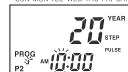
Nhấn phím **▼** 2 lần để cài đặt 10 và nhấn phím **SET** sau khi kiểm tra 00min.
