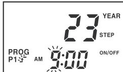
Nhấn phím **▼** để cài đặt 9 và nhấn phím **SET** sau khi kiểm tra 00min.
