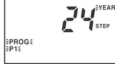
Nhấn phím [MODE] trong 3 giây trong mode RUN, "PROG P1" nháy và nhấn phím [MODE] 3 lần hơn đến khi "PROG P2 YEAR" nháy và nhấn phím [SET].
